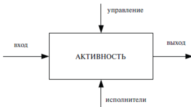
Рис. 2.1. Активность (работа), которая представляет функцию в нотации IDEF0
